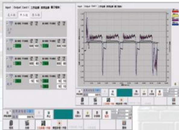
断刀管理系统设定刀具加工次数，刀具预估寿命。
